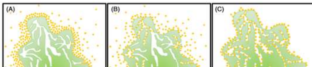
شکل ۱۲: شمایی از فرایند جذب آلاینده رنگی سانست یلو بر روی ذرات نانو پلیمر قالب مولکولی: (a) جذب سطحی اولیه، (b) نفوذ درون‌ذره‌ای و (c) جذب تک لایه‌ای از آلاینده رنگی در مراکز فعال جذبی پلیمر (۲۸).
