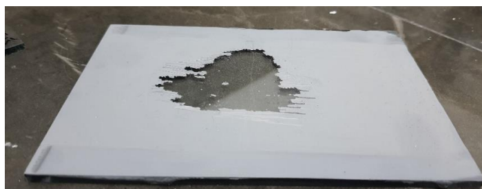
شکل ۳: نمایی از نحوه خراشیدن و جدا کردن پوشش غنی از روی از روی سطح شیشه.
