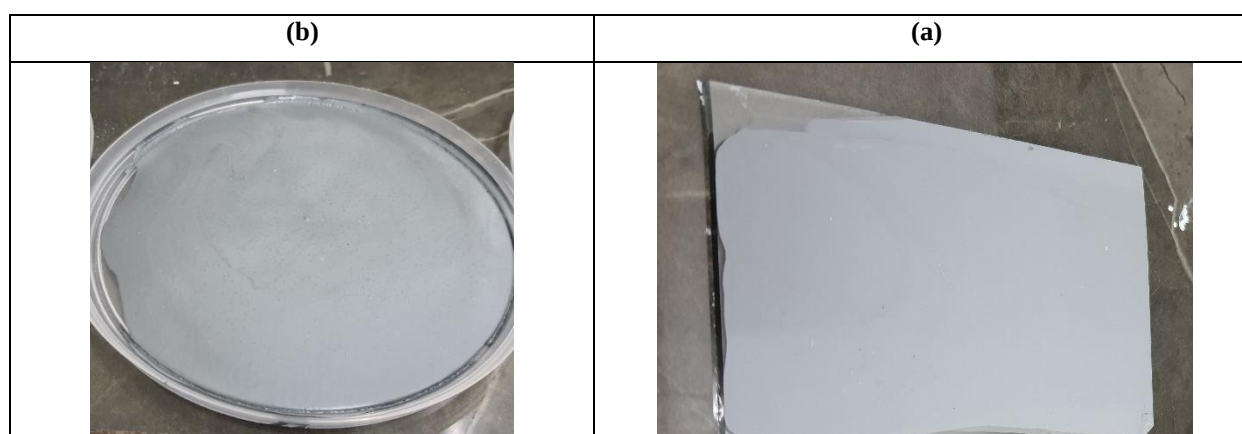
شکل ۲: تصویری از فیلم های اعمال شده (a) روی سطح شیشه و (b) روی سطح پلی پروپیلن، پس از یک هفته پخت در دمای محیط.
