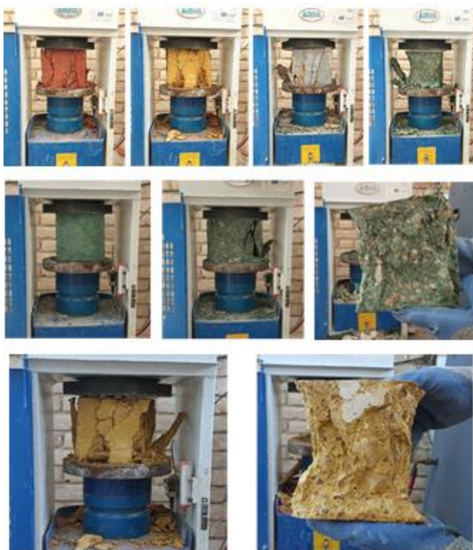
شکل ۸: آزمایش مقاومت فشاری نمونه‌های بتن مکعبی ۷ و ۲۸ روزه بتن‌های رنگی (۲، ۲۲، ۲۳).
