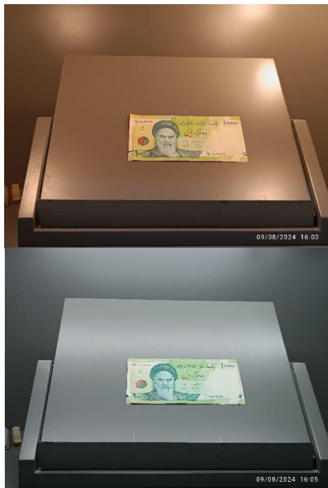
شکل ۱۰: نمایش اسکناس ۱۰ هزار تومانی زیر منبع روشنایی مرجع D65 (راست) و A (چپ).
