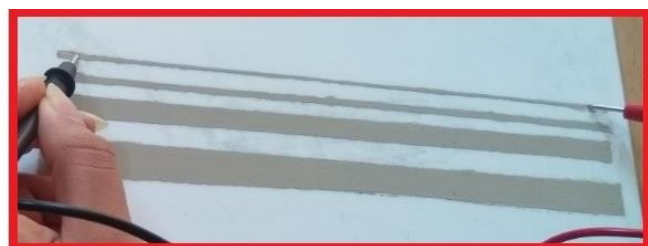
شکل ۱۰: نمایی از آزمون اندازه گیری مقاومت جوهرهای چاپ شده با ضخامت مختلف روی سطح PVC.
