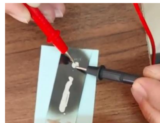
شکل ۲: نحوه اندازه‌گیری مقاومت ویژه جوهر چاپ شده به صورت دو نقطه.
