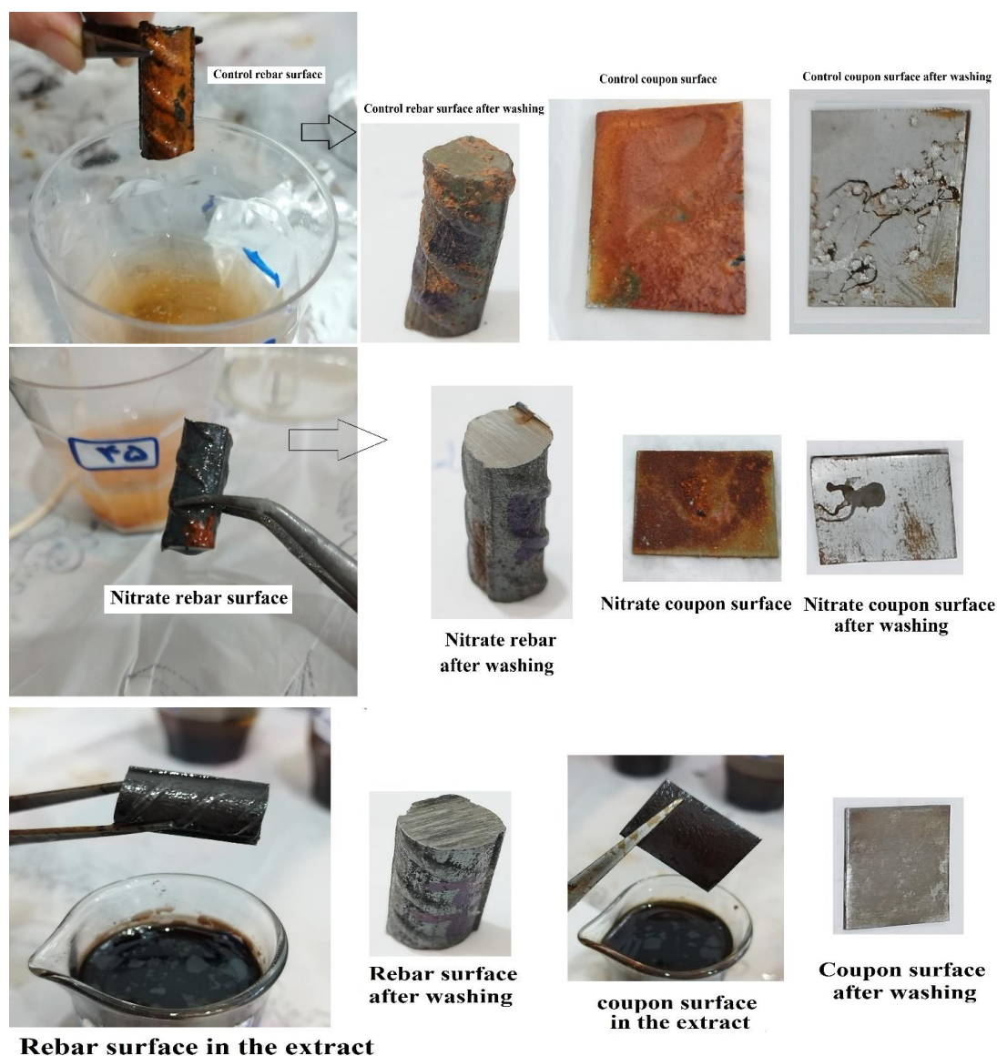
شکل ۲: ظاهر سطوح آرماتور و کوپن فولادی نمونه‌های مختلف بعد از دو هفته غوطه‌وری در شرایط تسریع شده آزمون کاهش وزن.
