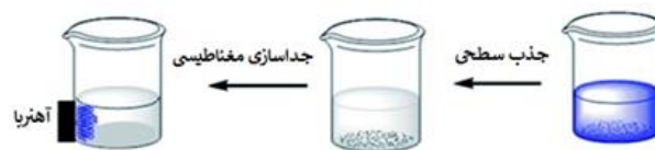
شکل ۲: جداسازی جاذب مغناطیسی از محلول حل شونده رنگی با استفاده از یک میدان مغناطیسی خارجی.
