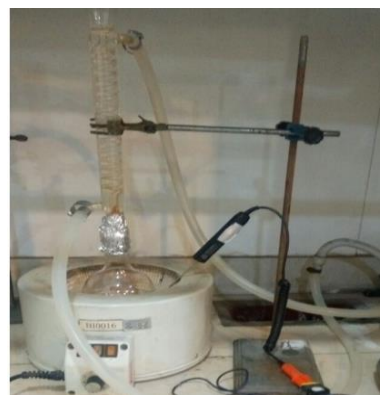
شکل ۲: سیستم رفلکس جهت تهیه نانو ساختار هیبریدی MLGO-Talc.
