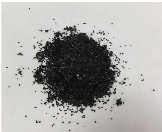
شکل ۱: تصویری از پودر تیره رنگ هیدروژل نانوجندسازه حاوی نانوذرات اکسید نیکل.
