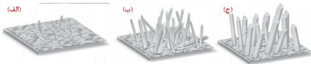
شکل ۳: شمایی از رشد نانومیله‌ها در دمای (الف) ۱۲۵، (ب) ۱۵۰ و (ج) ۱۷۵ درجه سانتی‌گراد [۱۸].
