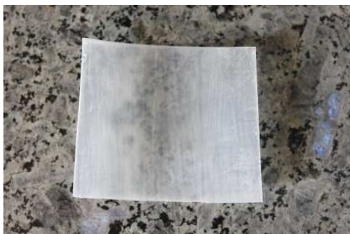
شکل ۴: تصویر سطح فیلم ۷ لایه‌ای متشکل از ۳ لایه پلی‌متیل‌متاکریلات و ۳ لایه پلی‌استایرن و یک لایه ضخیم پلی‌متیل‌متاکریلات به عنوان زیرآیند.
