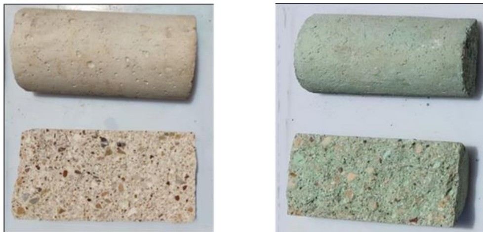
شکل ۷: سنجش مقاومت کششی نمونه‌های استوانه‌ای دارای رنگدانه فیروزه‌ای و شاهد.
