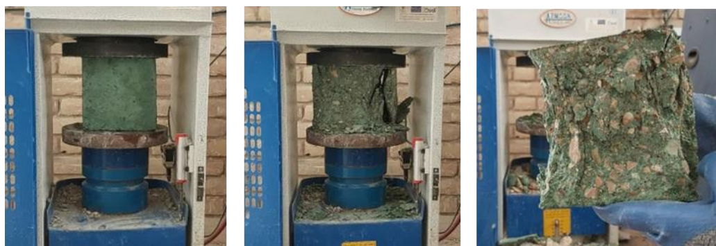
شکل ۵: آزمایش مقاومت فشاری نمونه‌های بتن مکعبی ۷ و ۲۸ روزه بتن فیروزه‌ای.
