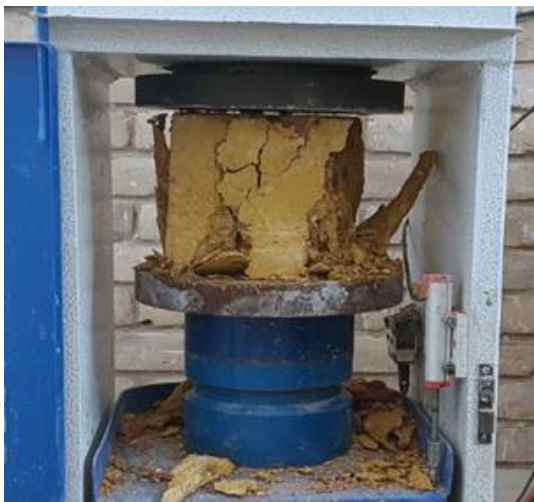
شکل ۷: سنجش مقاومت فشاری نمونه‌های بتن مکعبی دارای رنگدانه گل ماش.
