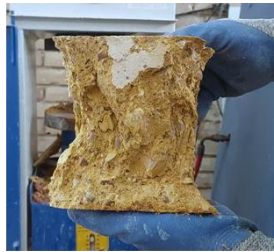
شکل ۷: سنجش مقاومت فشاری نمونه‌های بتن مکعبی دارای رنگدانه گل ماش.
