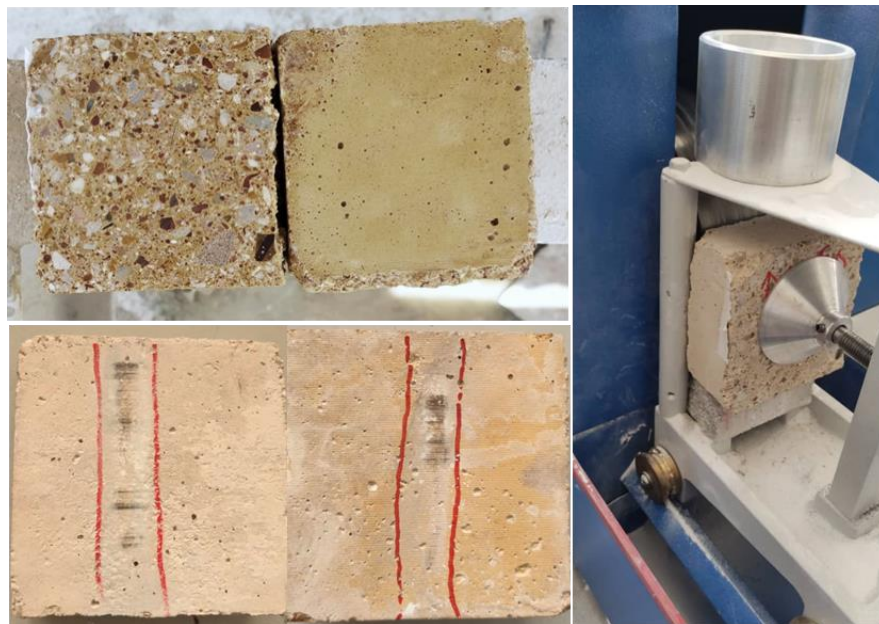
شکل ۱۰: آماده‌سازی و برش نمونه مکعبی به ابعاد ۵×۱۰×۱۰ سانتی‌متر جهت آزمون سایش.
