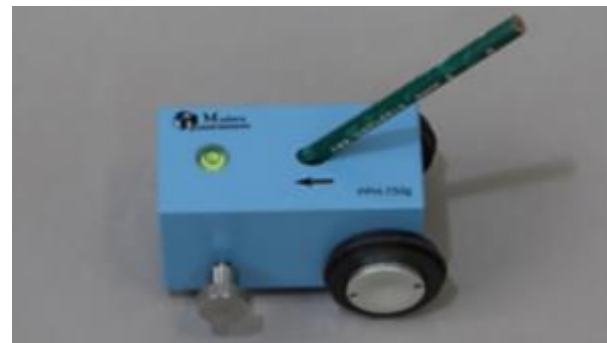
شکل ۳: دستگاه سختی سنج مداد.
