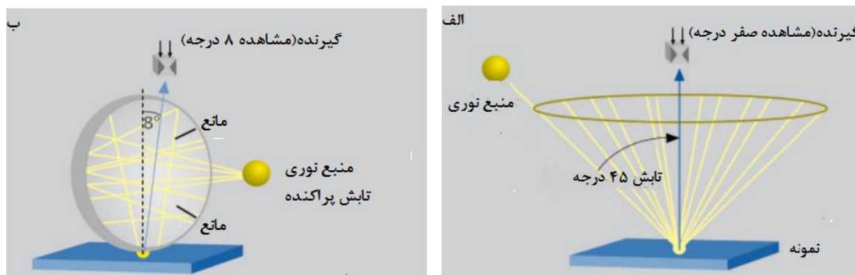
شکل ۵: نمایی از هندسه اندازه‌گیری الف) (45°a:0° و ب) (d:8°) [۸].
