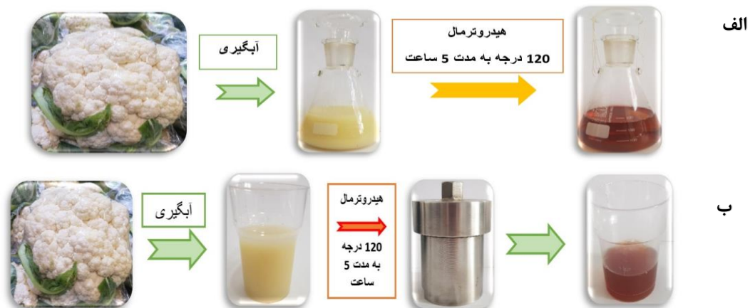
شکل ۲: تهیه آب گل کلم و سپس حرارت دادن در دمای ۱۲۰ درجه به مدت ۵ ساعت که نتیجه آن کربونیزه شدن و به دست آمدن محلول قهوه‌ای تیره است. الف) ارلن ساختگی و ب) اتوکلاو پوشش تفلونی.
