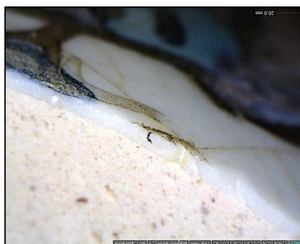
شکل ۲: کاربرد رنگ سیاه در رنگ گذاری به شیوه رولعابی، نمونه M22، با بزرگنمایی ۲۰۰ برابر در لوپ Dino Light.
