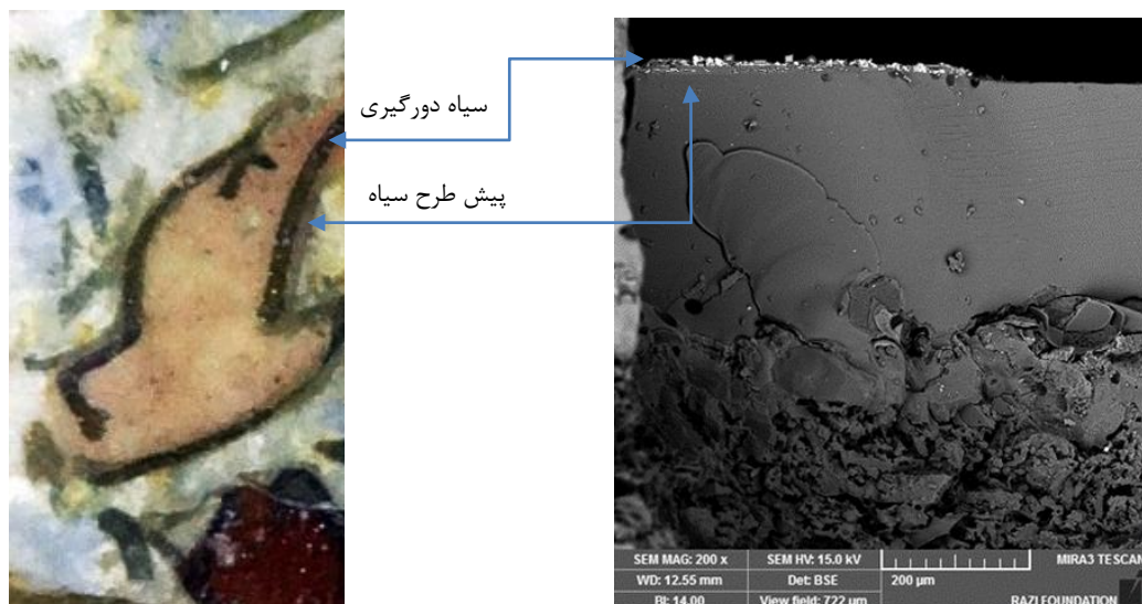
شکل ۹: تصویر میکروسکوپ الکترونی نمونه RG1754. رنگ سیاه به صورت رولعابی (ذرات براق سفید) روی طراحی اولیه سیاه کار شده است. فشردگی ذرات کرومیت و ضخامت بیشتر لایه رنگ، نسبت به پیش طرح، در تصویر مشاهده می‌شود.
