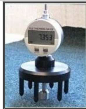
شکل ۳: دستگاه بارگذاری استاتیکی و ارتفاع‌سنج پرز فرش.
