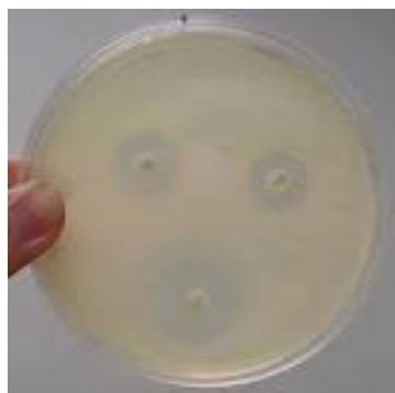
شکل ۴: میزان قطر منطقه عدم رشد به صورت هاله‌ای در اطراف دیسک.
