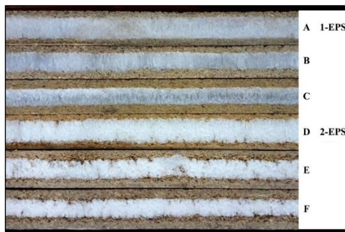
شکل ۱: نمای عرضی تخته‌های سبک‌وزن تولید شده در شرایط مختلف پرس.
