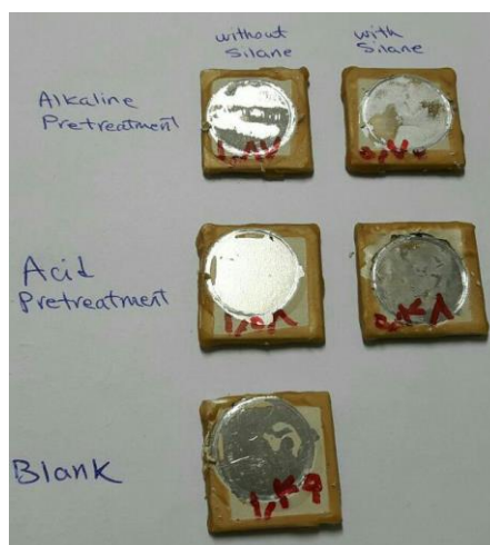
شکل ۶: تصویر نمونه‌ها بعد از کندن دالی جهت آزمون چسبندگی.
