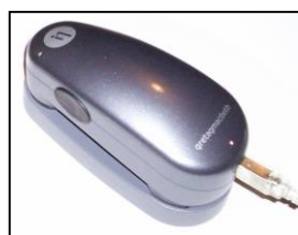
شکل ۳: دستگاه اسپکترورادایومتر مدل Eye-one [۳۳].
