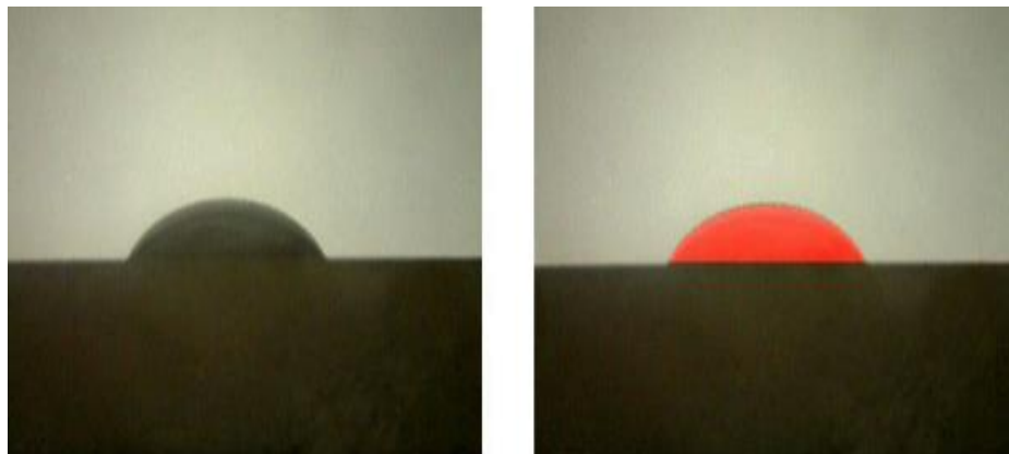
شکل ۱۱: مقایسه تصویر واقعی و تصویر پردازش شده، سمت راست) انطباق تصویر پردازش شده روی تصویر واقعی و سمت چپ) تصویر واقعی.
