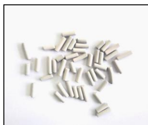
شکل ۲: نمایی از فوتوکاتالیزور تثبیت شده TM-APS (متوسط قطر و ارتفاع هر کدام به ترتیب: 3 و 10\text{ mm} ).
