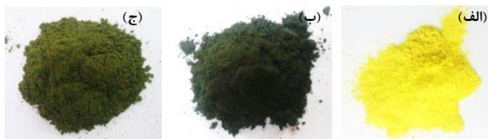
شکل ۸: تصاویر میکروسکوپی از نانورنگدانه‌های پودری ساخته شده به روش هیدروترمال و پخت داده شده در 770^\circ\text{C} (الف نمونه S1، ب S2 و ج S3).
