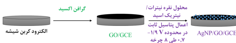
شمای ۲: مراحل اصلاح الکتروود کربن شیشه‌ای با اکسید گرافن و نانوذرات نقره.
