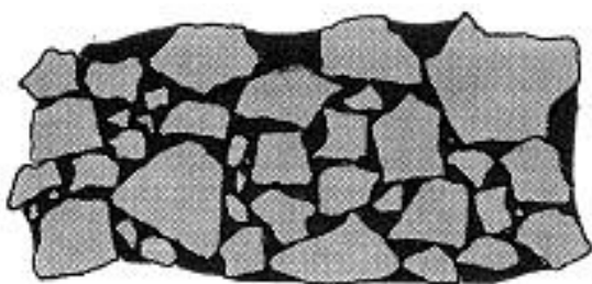
شکل ۱: طرح ترسیمی لایه ذرات آغشته شده با بست (صمغ عربی + عسل بر روی تکیه‌گاه کاغذی [۲۱]).
