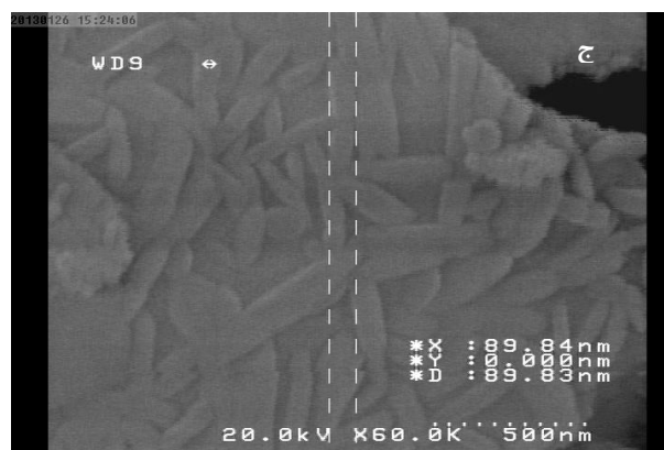
شکل ۵: (الف): تصویر SEM نانوذرات \text{LaZnAlO}_4 سنتز شده با سوخت نشاسته در \text{pH}=7 ( 15\text{ kV} )، (ب): تصویر SEM نانوذرات \text{LaZnAlO}_4 سنتز شده با سوخت نشاسته در \text{pH}=7 ( 20\text{ kV} )، (ج): تصویر SEM نانوذرات \text{LaZnAlO}_4 سنتز شده با سوخت گلیسرین در \text{pH}=7 ( 20\text{ kV} ).
