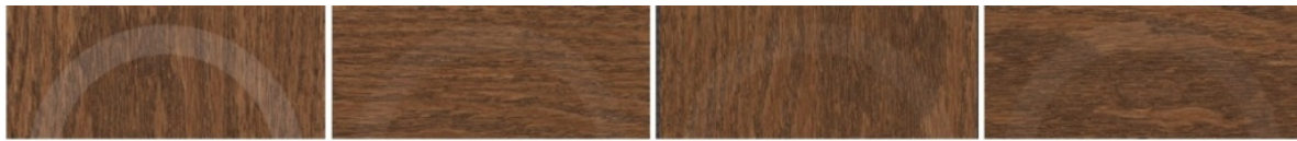
شکل ۵: نتایج آزمون سایش، (آ) نمونه رزین بدون نانوذره، (ب) نانوکامپوزیت حاوی ۱٪ نانوذره، (پ) نانوکامپوزیت حاوی ۳٪ نانوذره، (ت) نانوکامپوزیت حاوی ۵٪ نانوذره.
