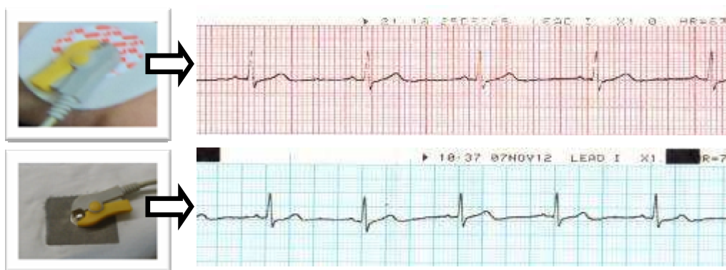
شکل ۱۲: ردیف بالا الکتروکاردیوگراف مرجع و پیام دریافتی از آن و ردیف پایین حسگر چاپی 3 \times 3 و سیگنال دریافتی آن.
