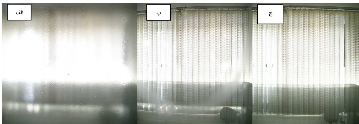
شکل ۱: تصاویر پلی‌کربنات پوشش داده شده با پوشش هیبریدی: الف) نمونه با نسبت آب به آلکوکساید برابر با ۱,۵، ب) نمونه با ترکیب درصد مشابه الف اما با نسبت آب به آلکوکساید برابر با ۱ (پس از سایش)، ج) نمونه ب قبل از سایش.
